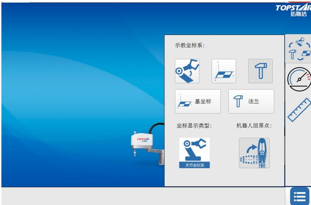
图 4-7 机器坐标系切换
