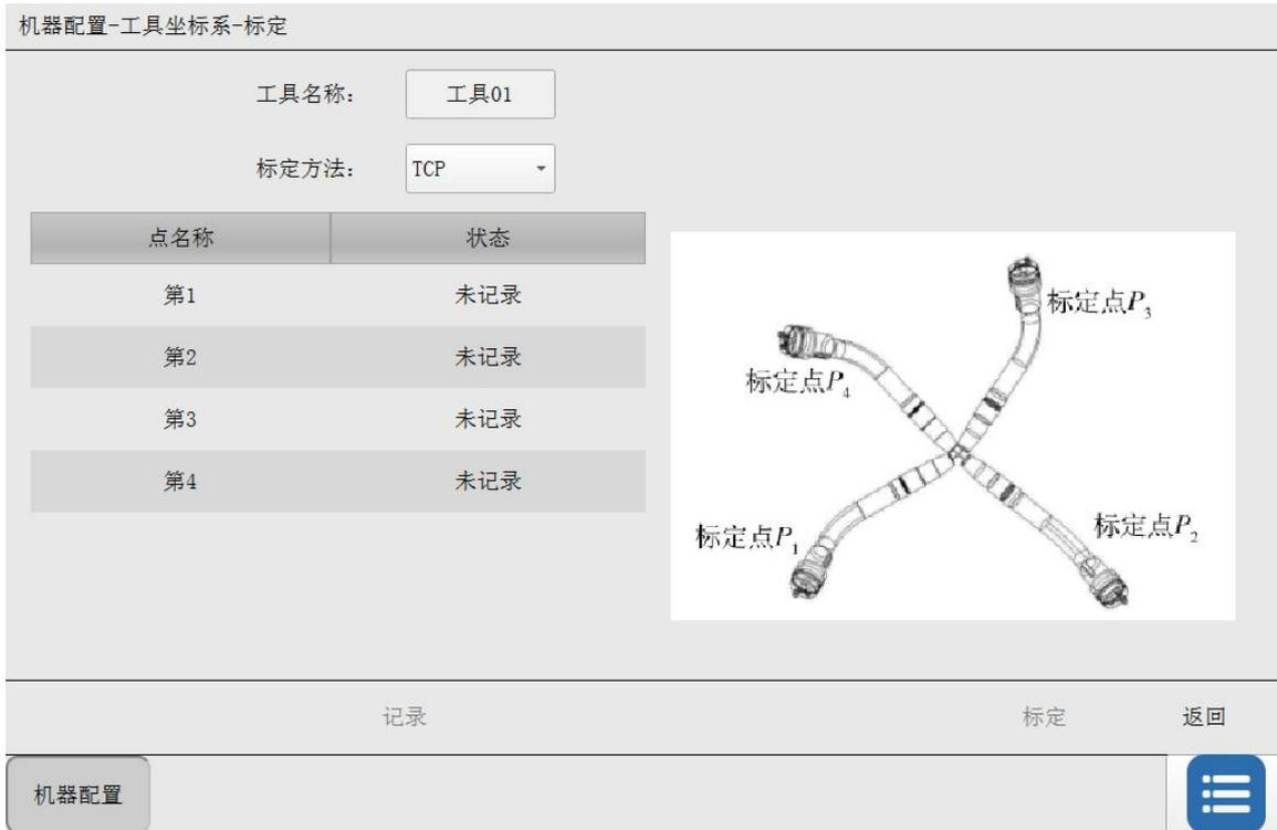
图 4-33 工具坐标系标定界面
