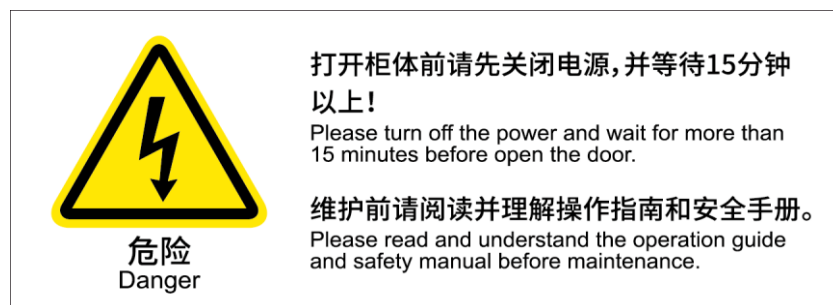
图 2-7 开门断电&amp;维护指示牌
