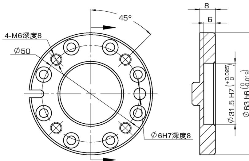
图 6-7 拓星际 R092-07-B 型操作机腕部法兰尺寸示意图
