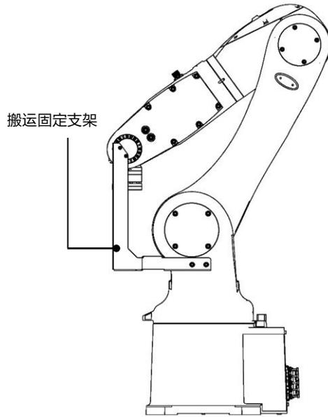
图 3-3 拓星际R092-07-B 型操作机搬运位姿图
