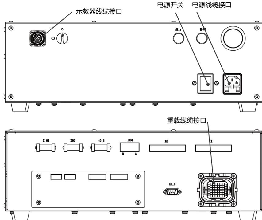
图 5-4 拓星际R092-07-B 控制柜示意图
