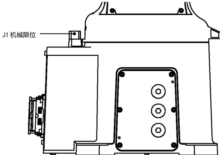
图 6-2 拓星际R092-07-B 型操作机上机械式制动器
