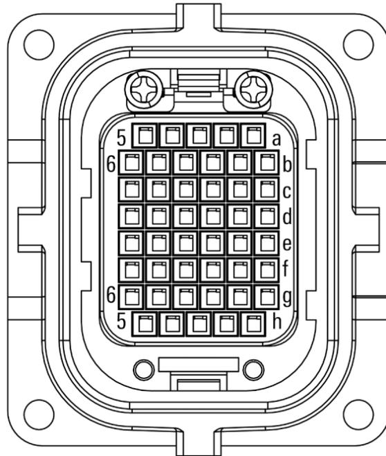
图 4-3 拓星际R092-07-B 型操作机重载接口
