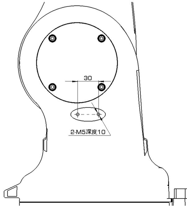
图 6-12 拓星际R092-07-B J1 轴本体接口尺寸图
