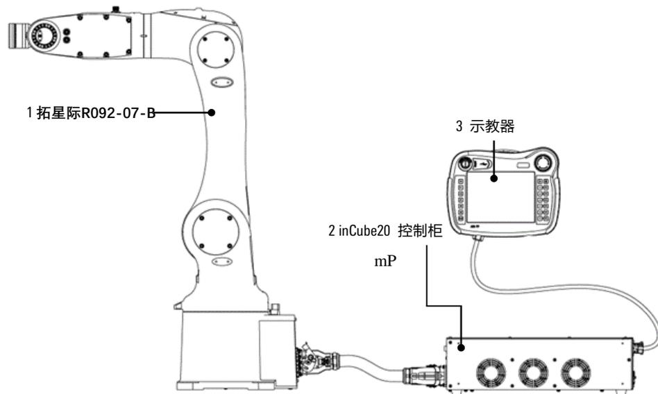
图 2-1 拓星际R092-07-B 工业机器人系统的构成
