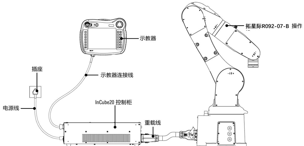
图 5-8 拓星际R092-07-B 工业机器人系统接线概览
