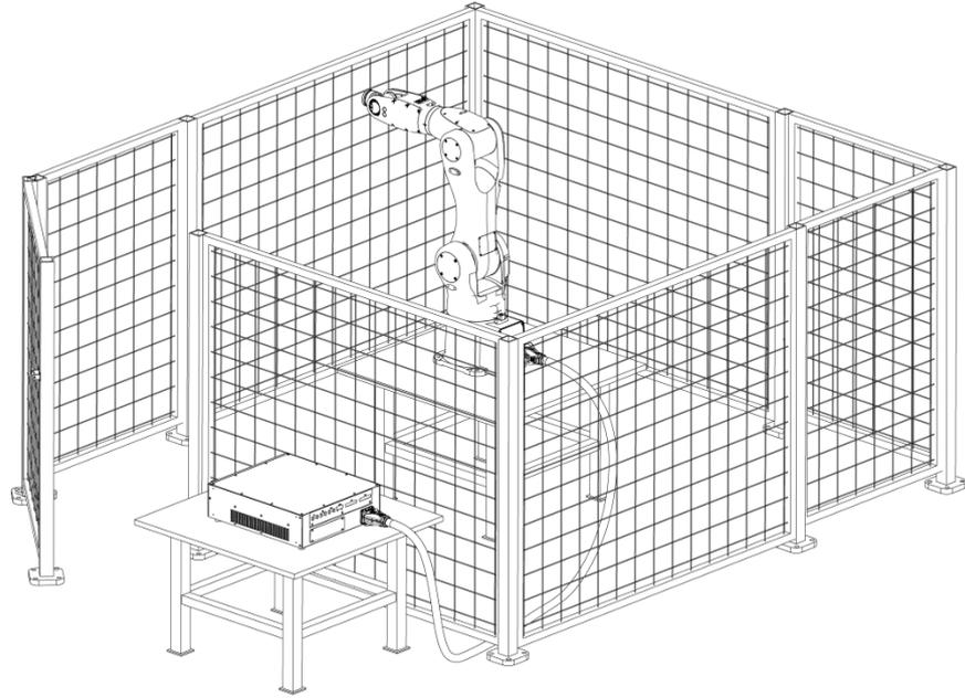
图 1 工业机器人安全工作示意图
