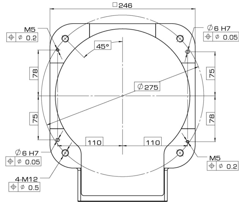
图 3-7 拓星际R092-07-B 型操作机基座接口尺寸
