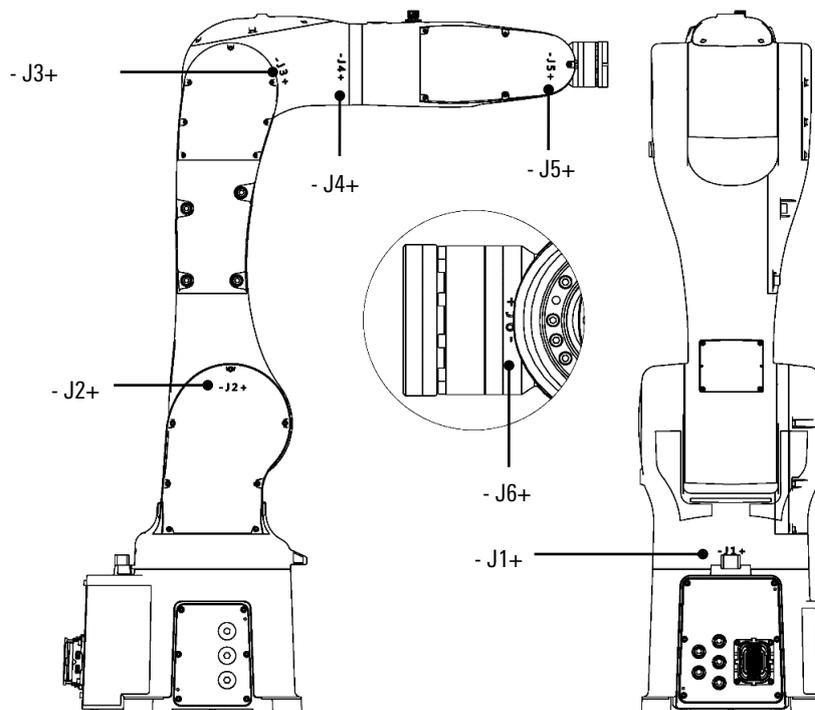
图 2-7 操作机上各轴方向标识
