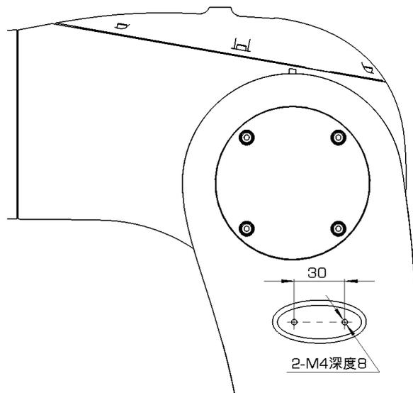
图 6-11 拓星际R092-07-B 大臂接口尺寸图
