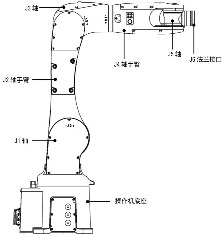
图 2-2 拓星际R092-07-B 型机器人本体及其各个部分
