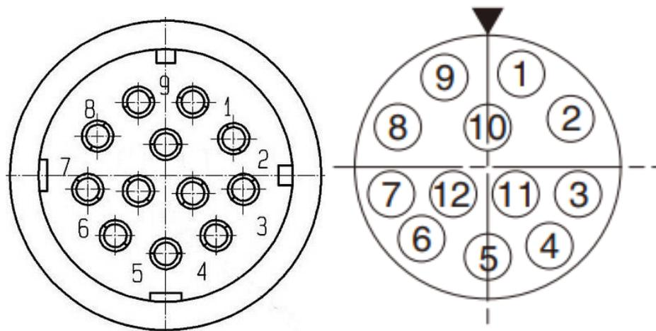
图 4-4 拓星际R092-07-B 型操作机小臂 I0 接口
