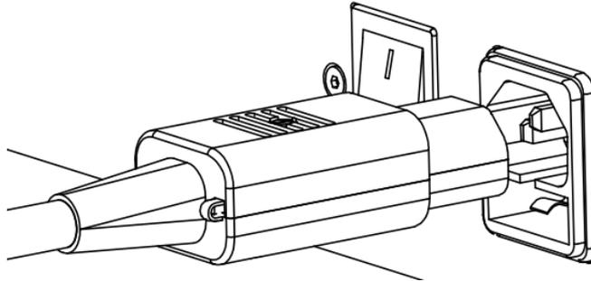
图 5-9 电源线连接接口
