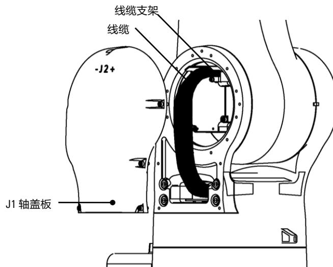
图 9-2 J1 轴本体内部线缆检修
