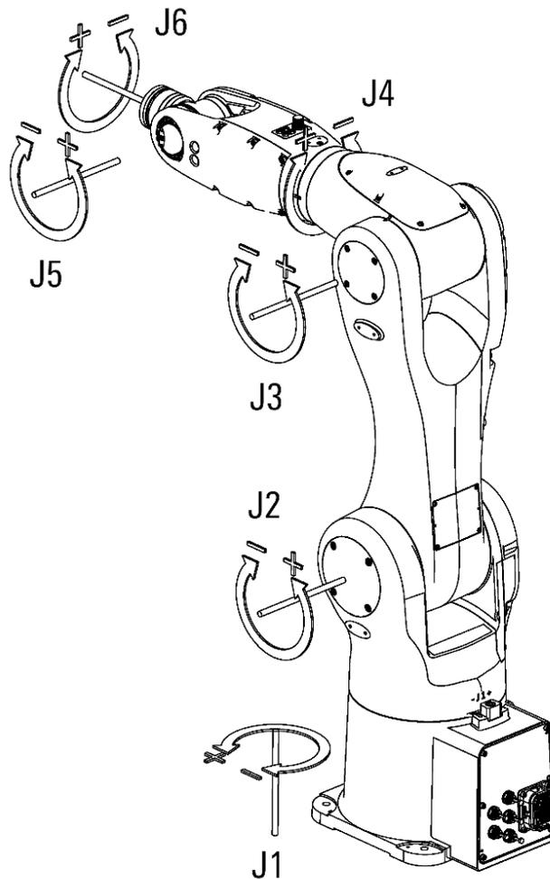
图 6-6 操作机各轴运动方向
