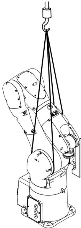
图 3-6 拓星际R092-07-B 吊环搬运示意图
