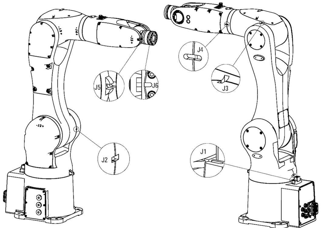
图 6-3 拓星际R092-07-B 各轴零点示意图
