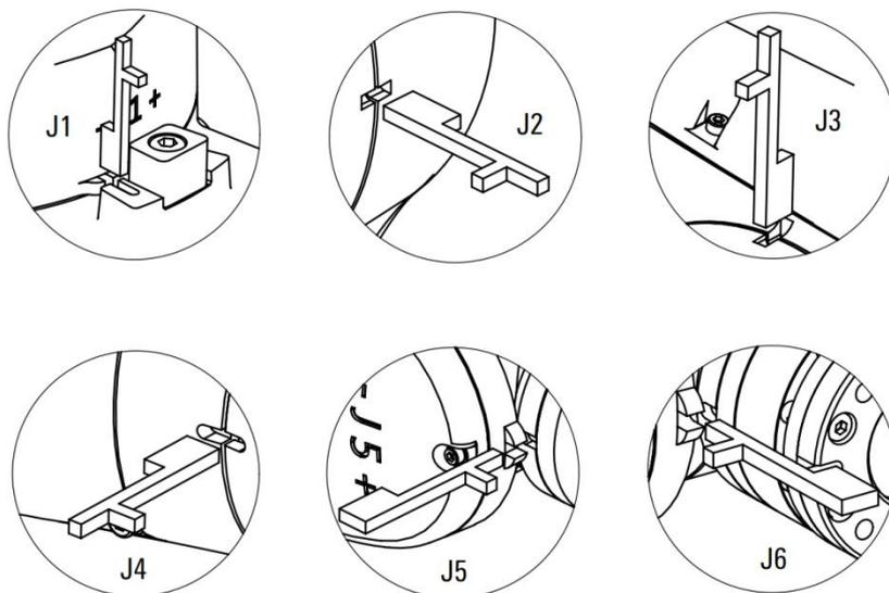
图 6-5 零点标定块标定方式
