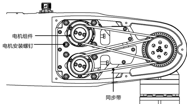
图 9-6 拆卸同步带
