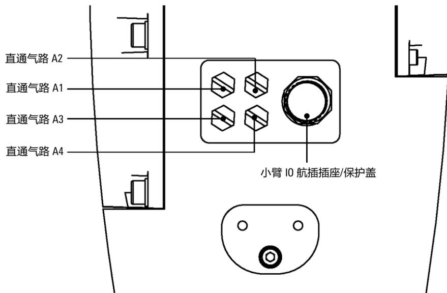
图 4-2 拓星际R092-07-B 型操作机小臂上接口
