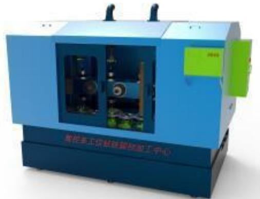
◆ 多工位梁柱材成型钻铣锯刨加工中心
