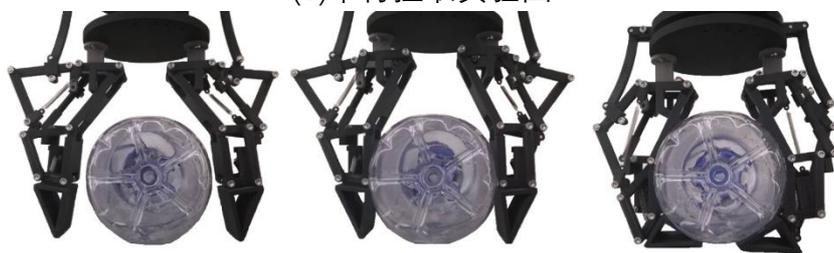
(e)自适应包络抓取实验图
